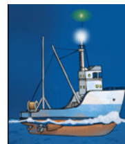
Bateau de pêche en train de chaluter et faisant route mais qui n'avance pas, deux feux visibles sur tout l'horizon, à la verticale, celui du haut est vert, l'autre au bas est blanc
