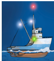
Bateau en train de pêcher la nuit, montrant des feux de côté et un feu rouge visible sur tout l'horizon
